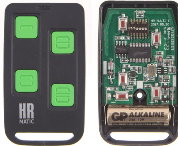
2.- Stellen Sie den DIP-switch in den richtigen position, je nach dem ursprünglichen Handsender.
