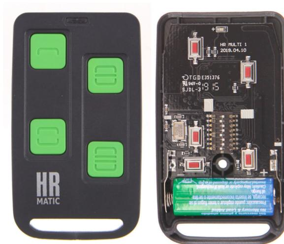
2.- Stellen Sie den DIP-switch in den richtigen position, je nach dem ursprünglichen Handsender.
